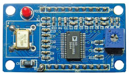
Figure 1 — The DDS module.
